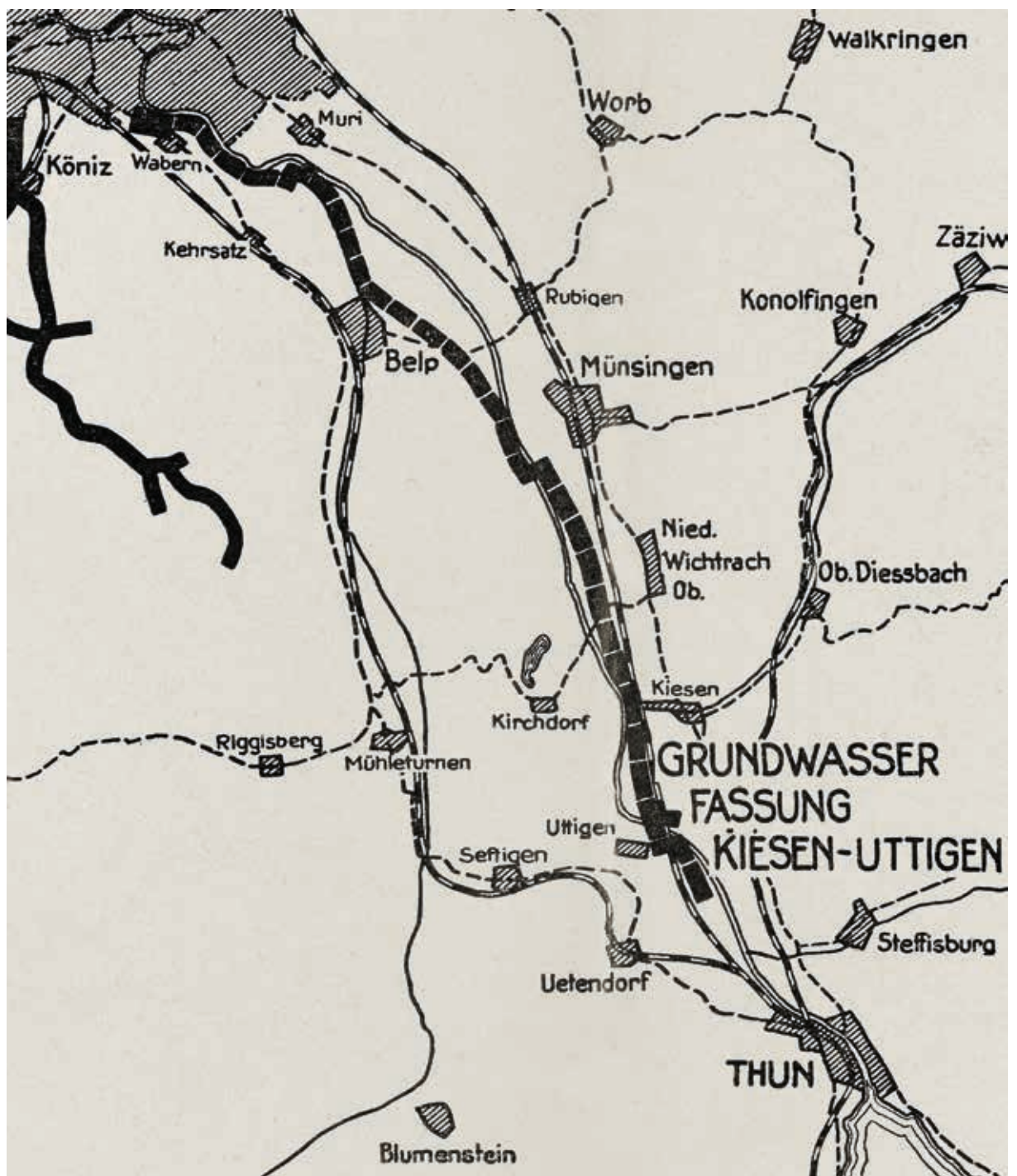
Ausschnitt aus «Schematische Übersichtskarte der Wasserversorgung (bestehende Anlagen und Aaretalwerk)» – projektierte Anlage von 1965.
