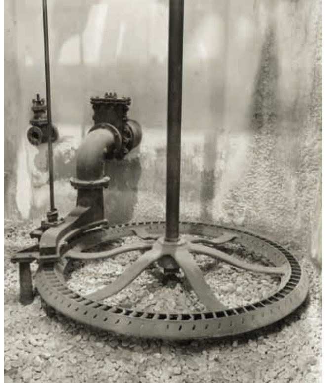
Das horizontal liegende Wasserrad, das durch den Zufluss aus dem Stadtbach betrieben wurde.
